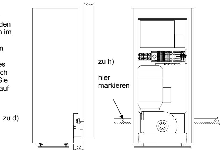
Achten Sie auf waagerechte Lage. Markieren Sie mit einem Stift durch das Befestigungsloch der Zahnstange auf das Tor.
